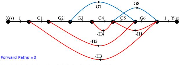
$P_1 = G_1G_2G_3G_4G_5G_6$ ;  $P_2 = G_1G_2G_7G_6$   $P_3 = G_1G_2G_3G_4G_8$
